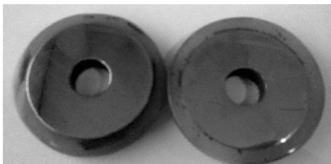
Рис. 6 – Образцы, подготовленные для исследования микротвердости
