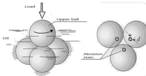
Fig. 3. Friction node
